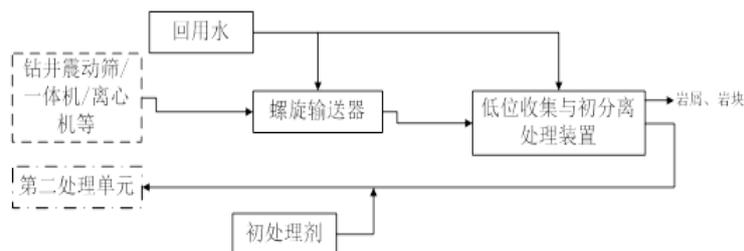
图 7.1-2 第一单元工艺流程图
