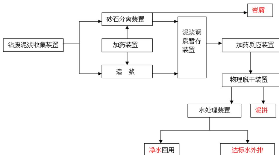
图 7.1-1 不落地处理工艺流程图
