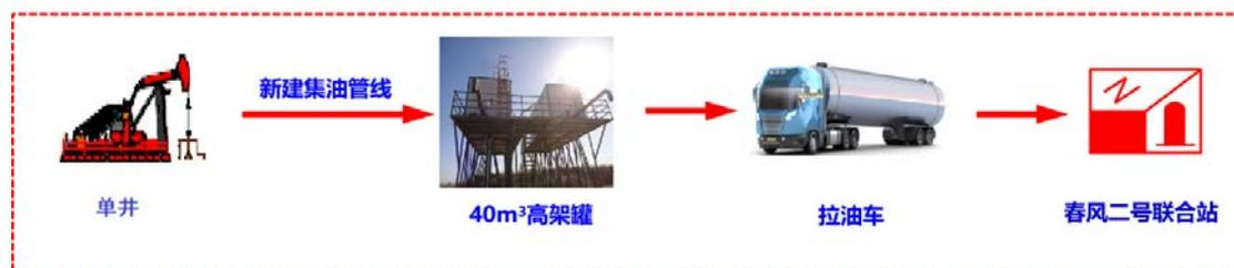
图 3.1-4 集输流程示意图
