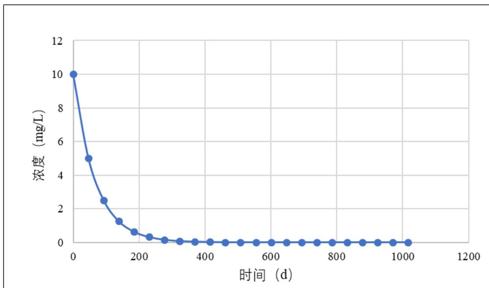
图 5.4-4 有机污染物的一级衰减曲线
