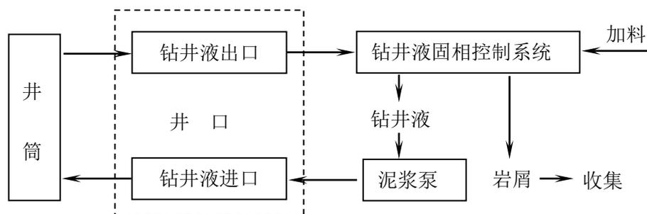
图 3.2-1 钻井液循环示意图
