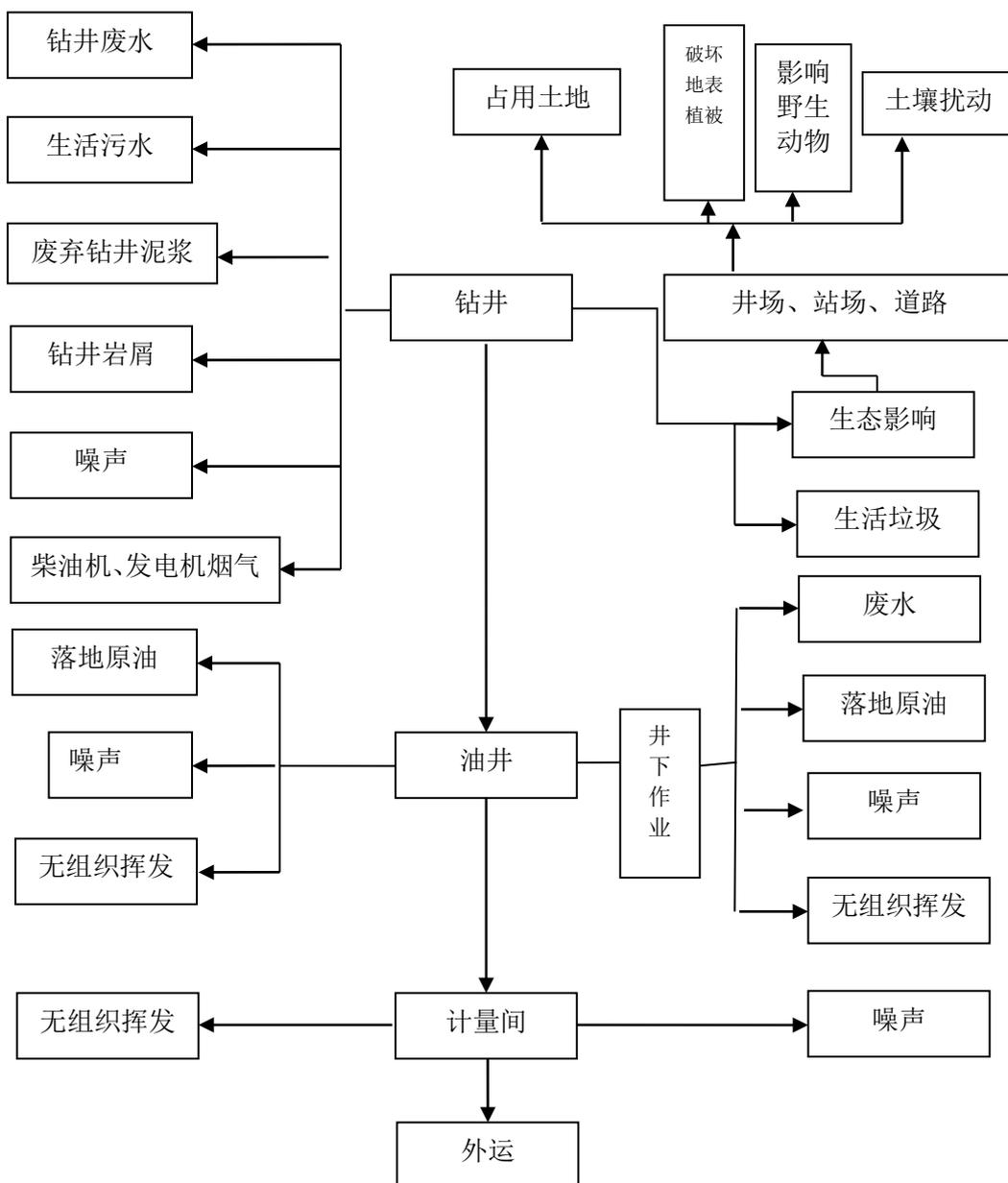
图 3.2-2 油田开发过程污染物排放流程
