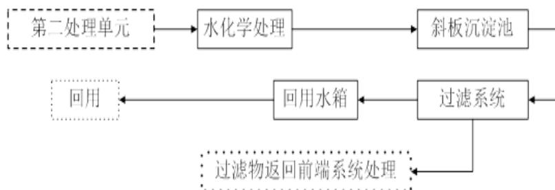
图 7.1-4 第三单元工艺流程图
