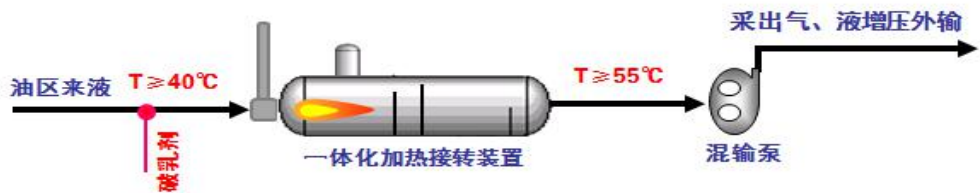
转油站工艺流程图
