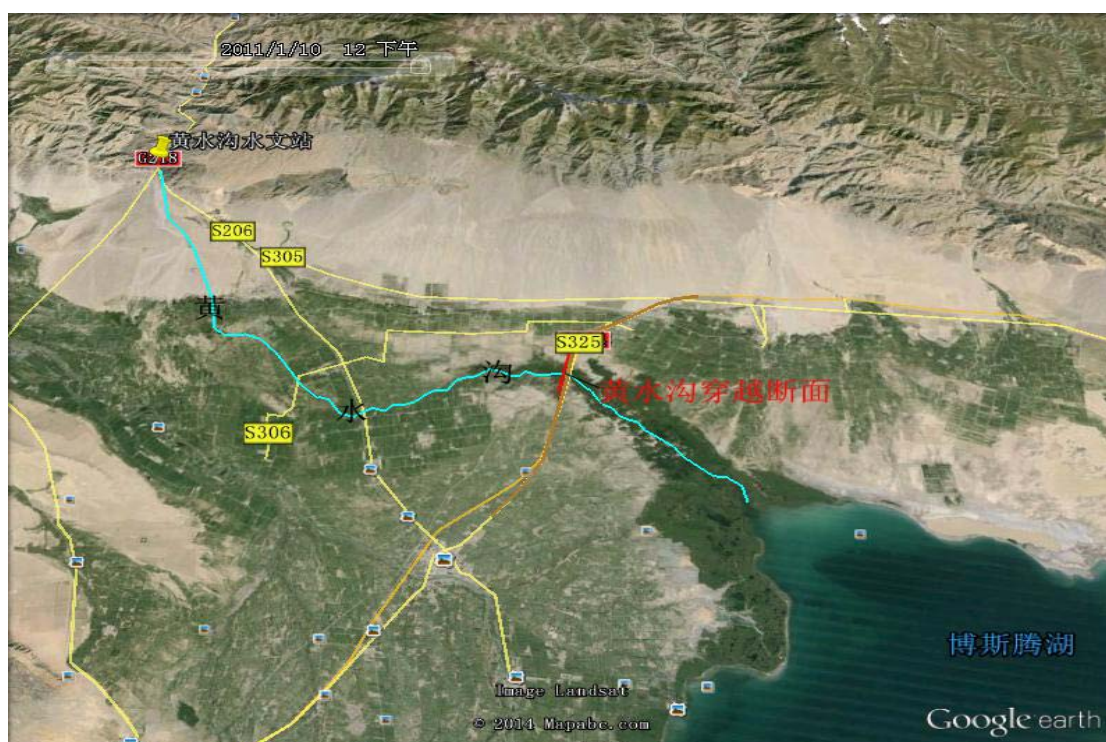
图 3.2-3 改线管道与黄水沟位置关系
