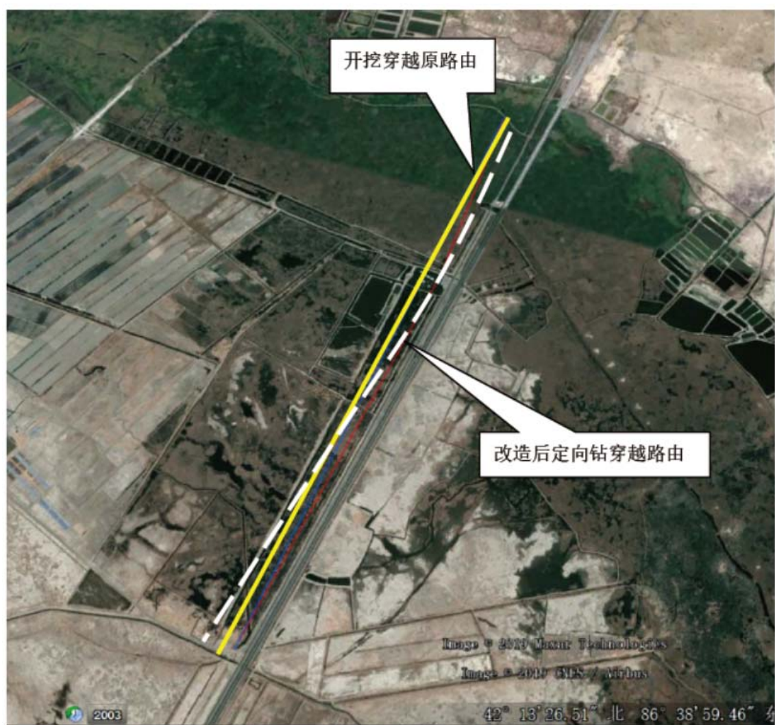
图 3.2-2 原管道与改线管道位置关系
