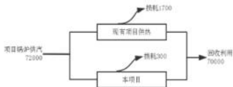
图 4.7-3 本项目建成后全厂蒸汽平衡图
