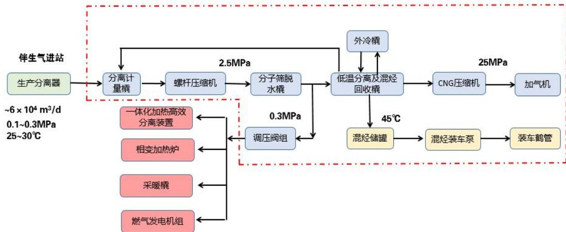
伴生气处理工艺流程框图
