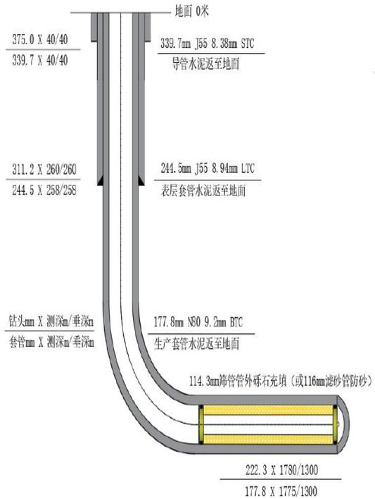
套管固井射孔完井
