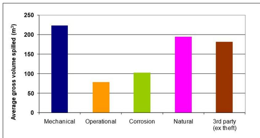
图7.3-4 CONCAWE 输油管道不同事故原因导致溢油事故泄漏量统计结果
