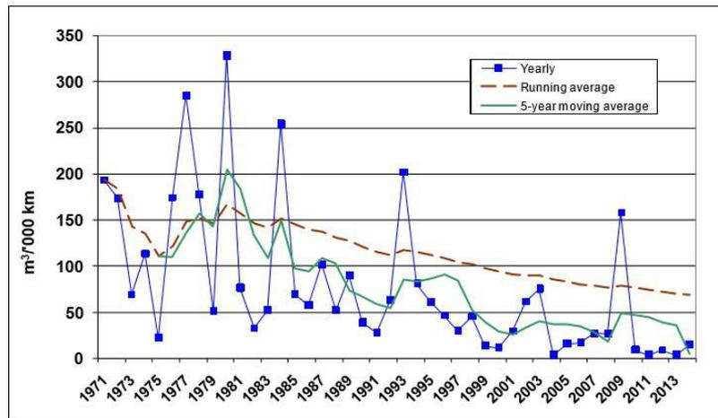
图 7.3-3 CONCAWE1971-2014 年输油管道溢油事故泄漏量统计结果
