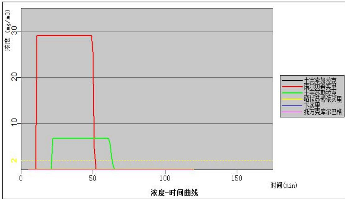
图 7.5-5 风向为 WS 时各关心点 SO<sub>2</sub> 最大浓度随时间变化图
