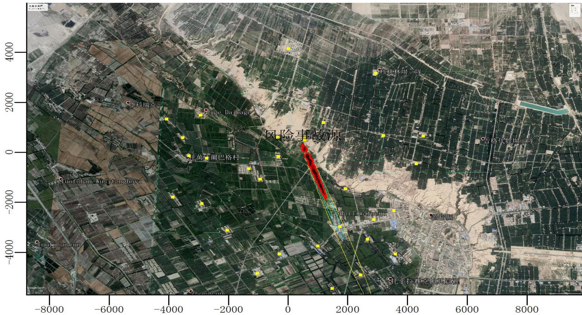
图 7.5-3 项目主导风向下风向 CO 阈值区间等值线图
