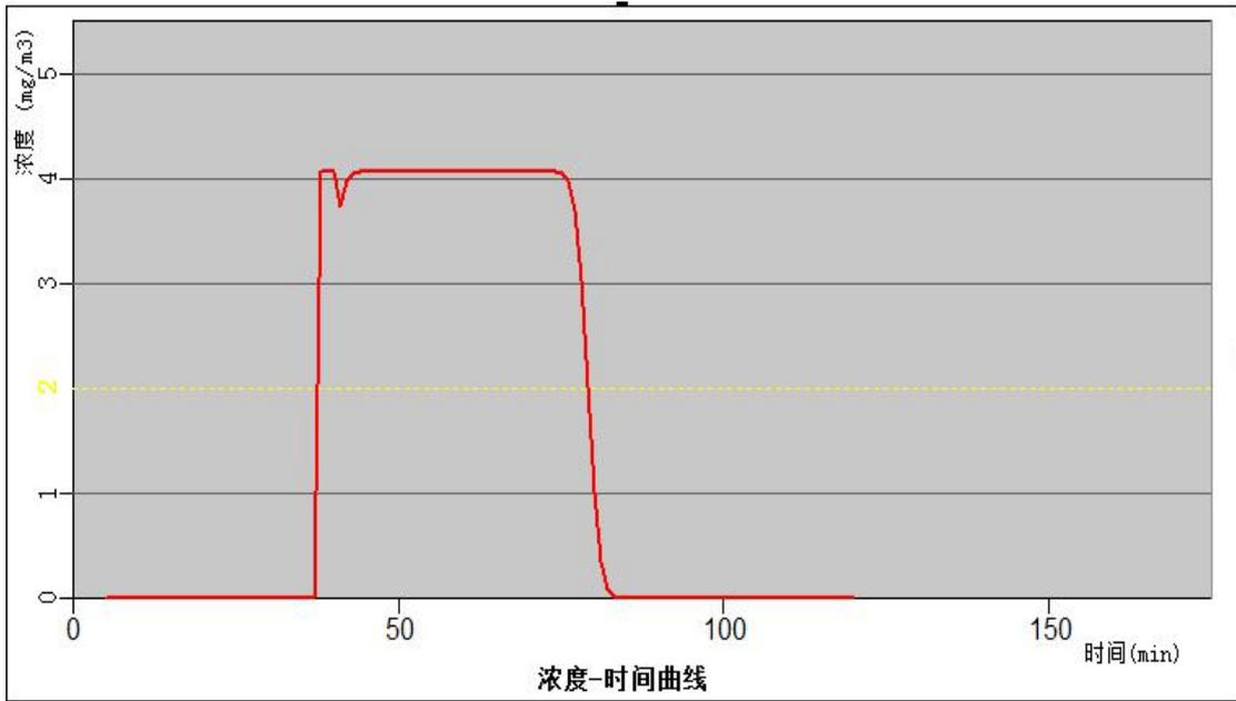
图 7.5-7 主导风向时托乎拉乡 SO<sub>2</sub> 最大浓度随时间变化图
