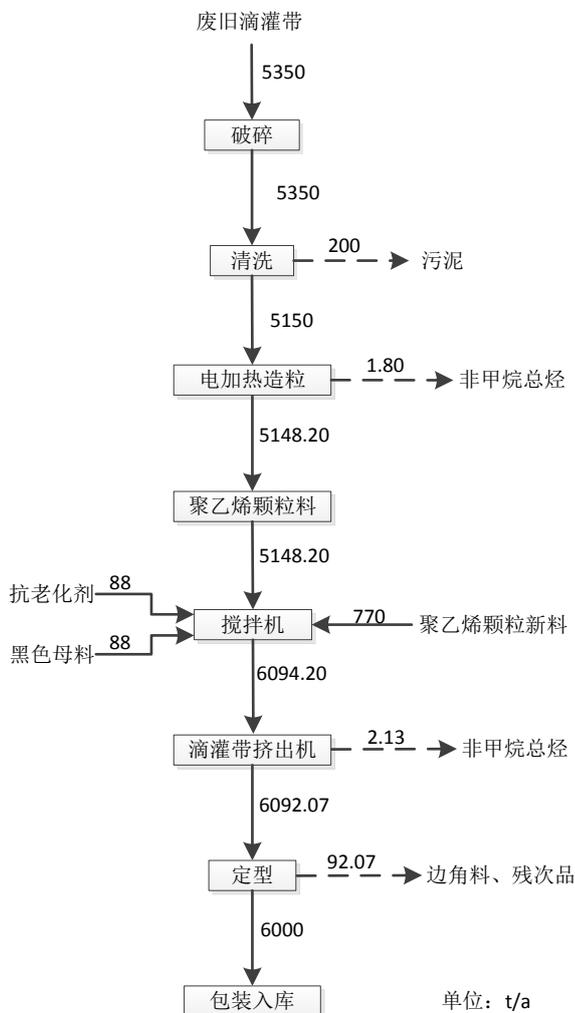
图3.4-1 滴灌带生产线物料平衡图
