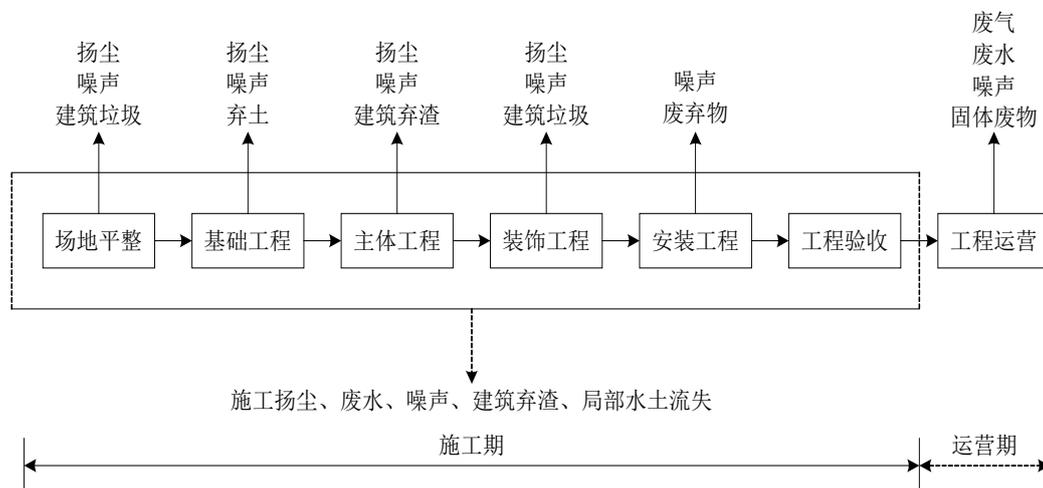
图 3.3-1 项目施工期工艺流程及产物节点图
