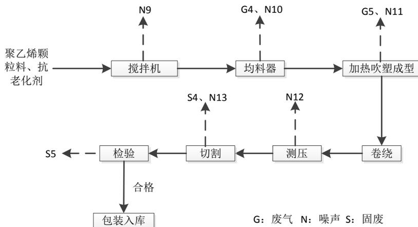
图3.3-4 地膜生产线工艺流程及产污环节图
