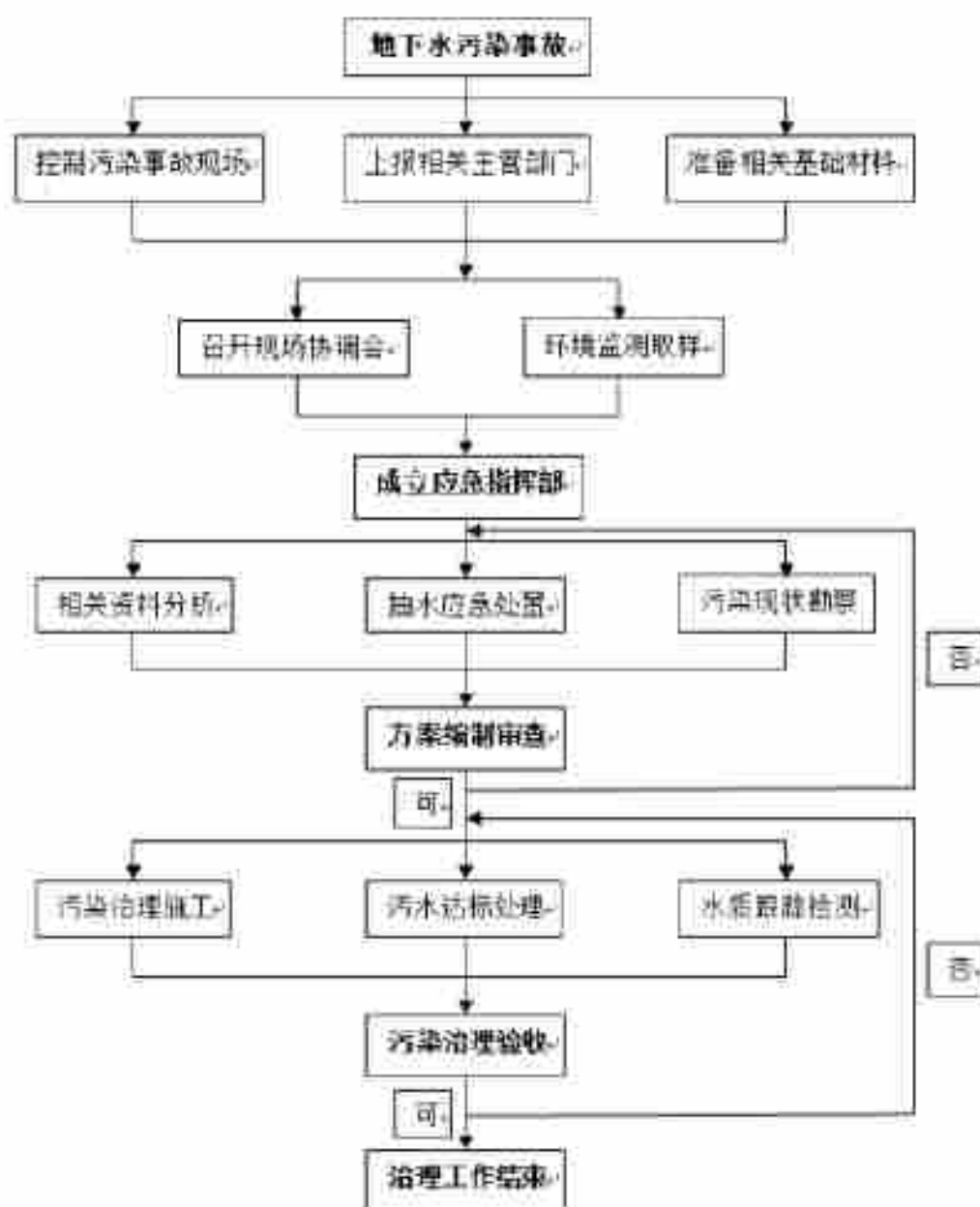
图 6.3-3 地下水污染应急治理程序框图
