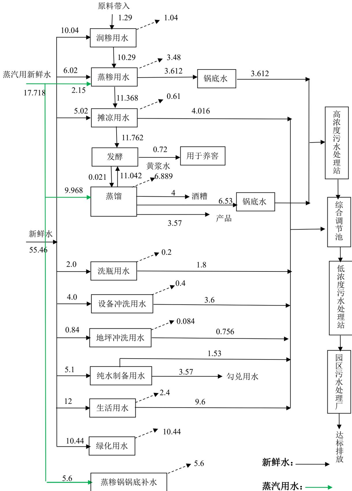
图 3.2-5 本项目水平衡图 (m³/d)
