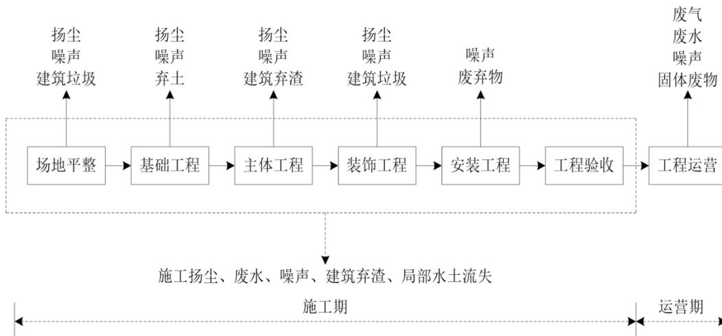
图 3.2-1 项目施工期工艺流程及产污节点图
