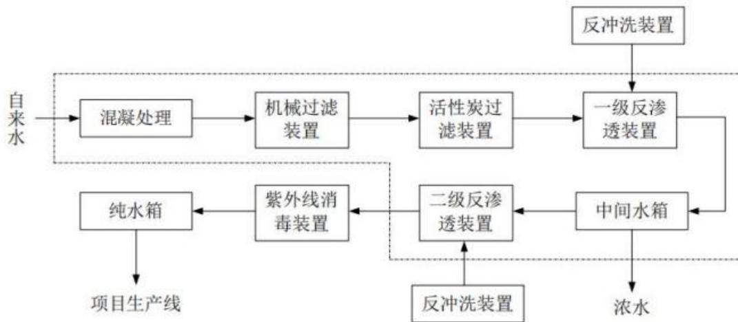
图 3.2-4 双级反渗透生产工艺流程示意图
