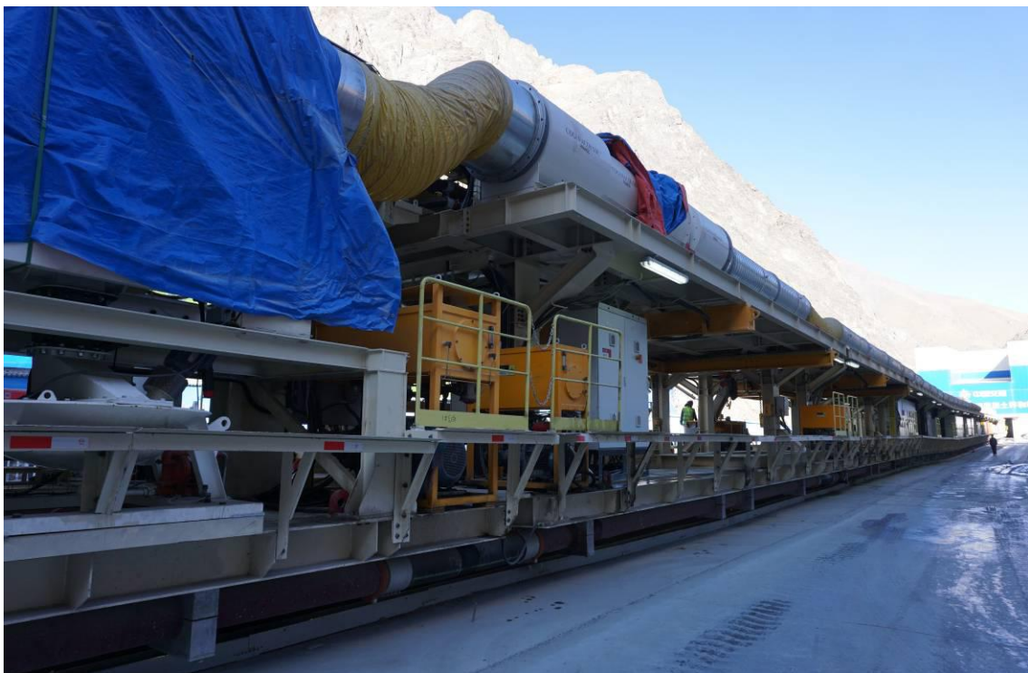
图 2.4-8 TBM 设备进场布置图
