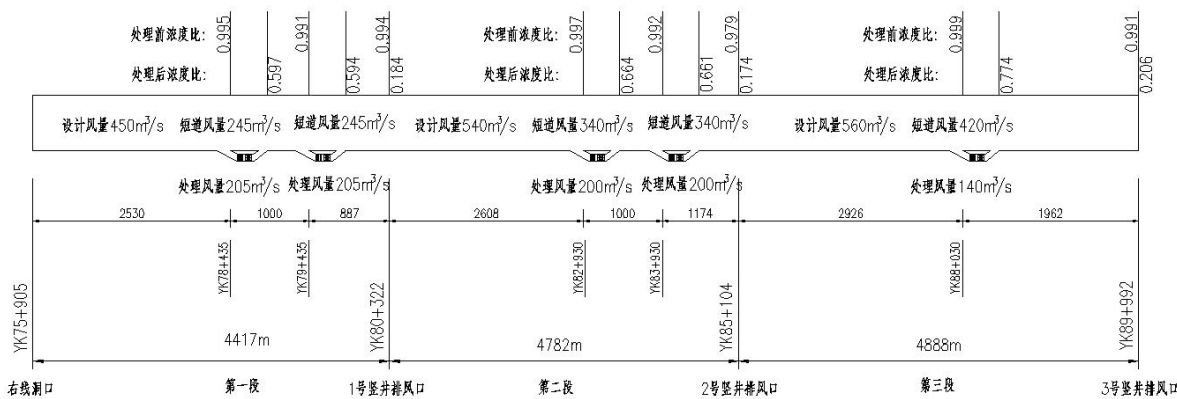
图 2.5.2-11 旁通式除尘设备布置及烟雾浓度校核
