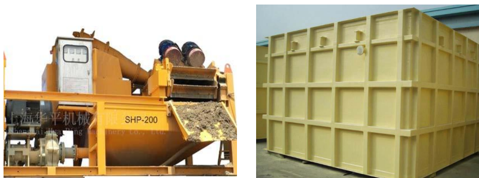
图 2.5.5-1 泥浆净化装置和钢制泥浆池
