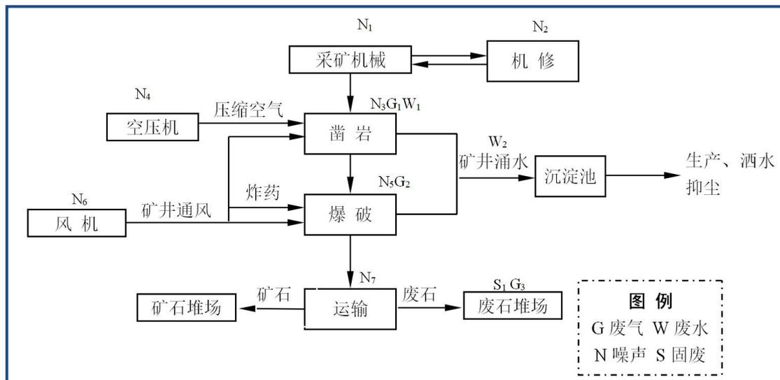
图 3.2-1 矿山开采工艺流程及排污节点图
