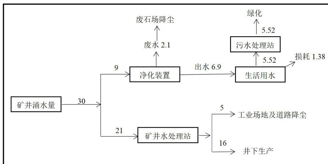
图 3.1-3 项目水平衡图 单位：m<sup>3</sup>/d
