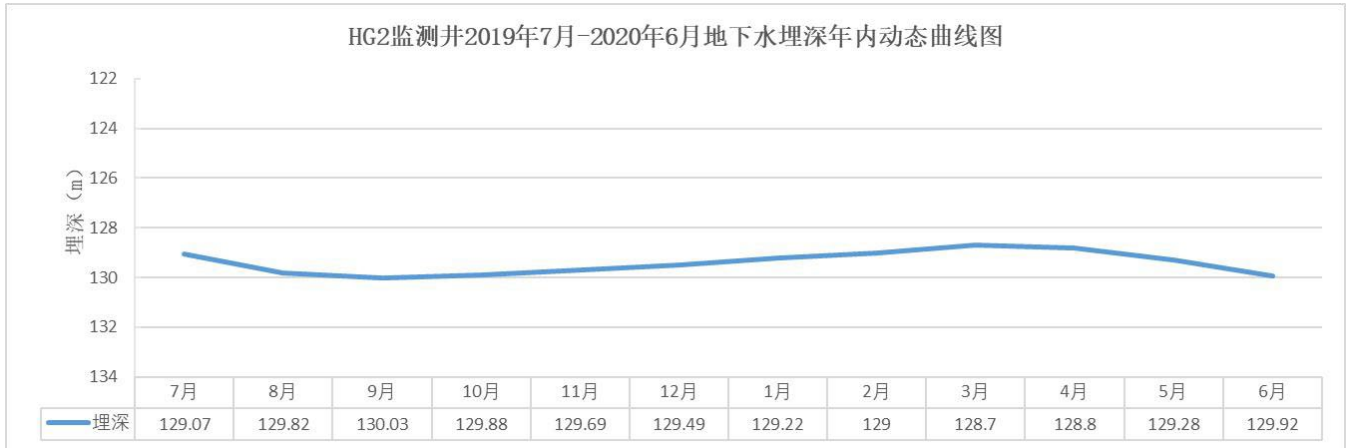
图 5.2-13 HG2 监测井地下水位年内动态曲线图
