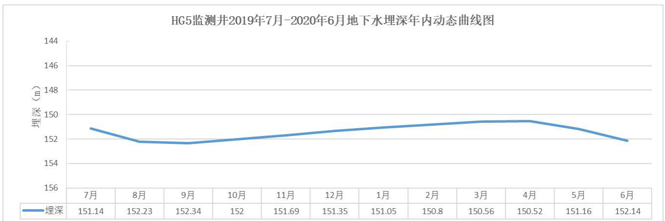
图 5.2-15 HG5 监测井地下水位年内动态曲线图
