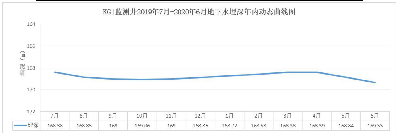
图 5.2-16 KG1 监测井地下水位年内动态曲线图
