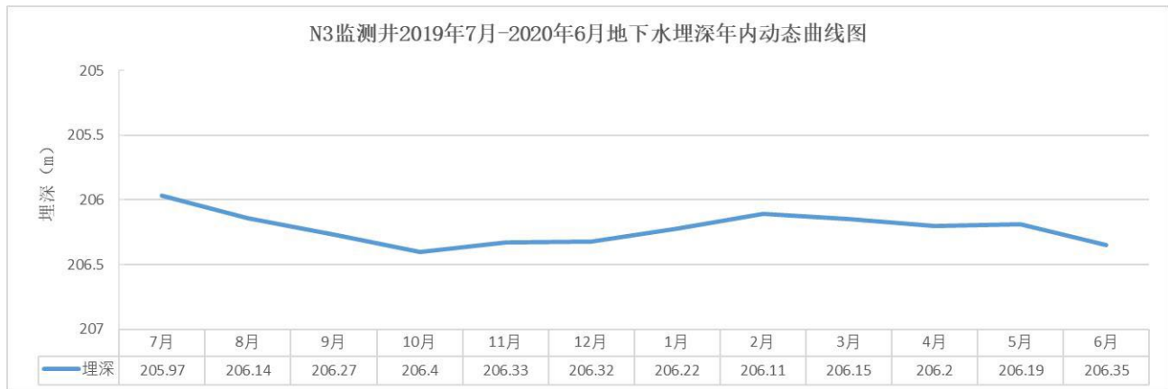
图 5.2-11 N3 监测井地下水位年内动态曲线图
