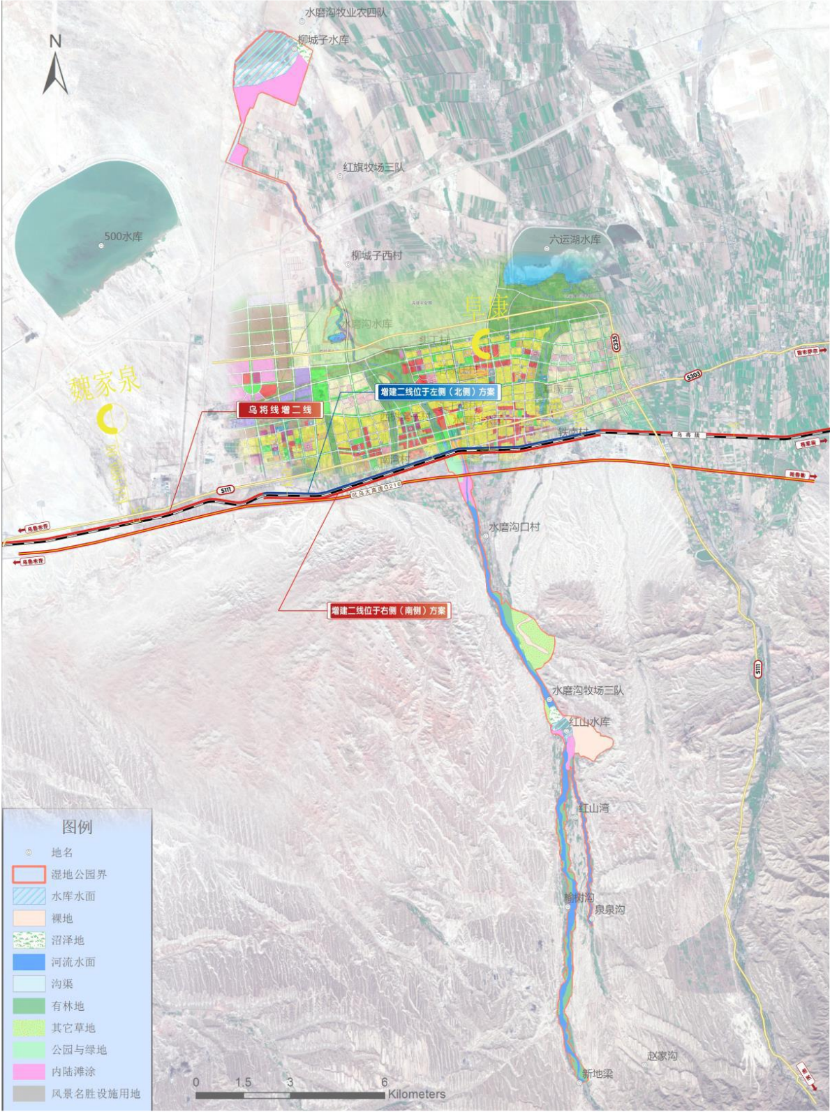
图 4.2-1 增建二线沿既有线左、右侧方案比选示意图
