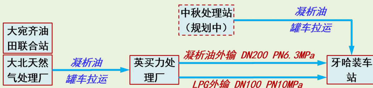
图 4.1-5 气田周边区块液体产品外输系统示意图
