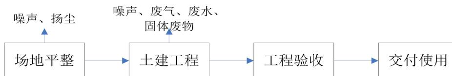
图 3-7 施工期主要工艺流程及产污环节
