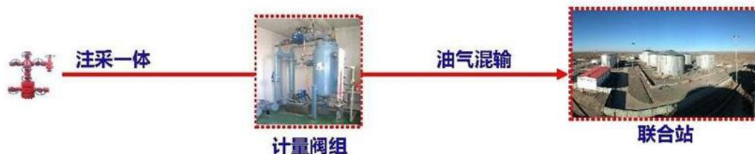
图 3.2-1 本项目布站工艺流程图
