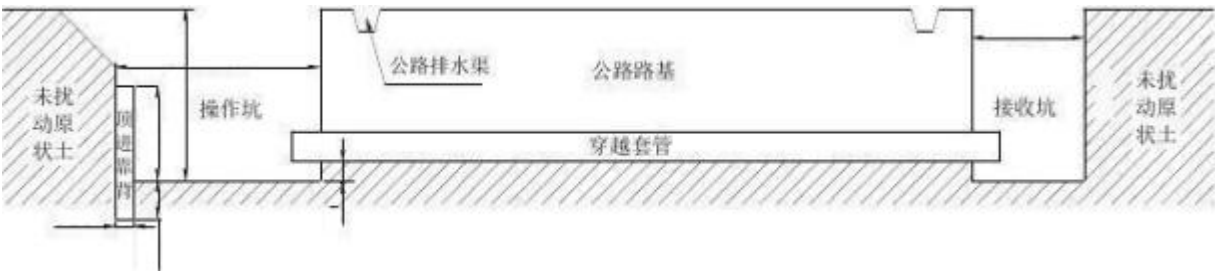
图 3.4-2 穿越道路施工作业示意图
