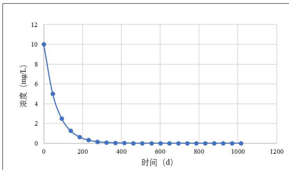
图 5.4-3 有机污染物的一级衰减曲线
