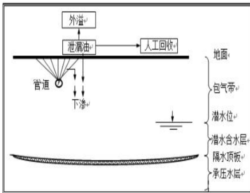
图 5.6-1 溢油污染过程示意图
