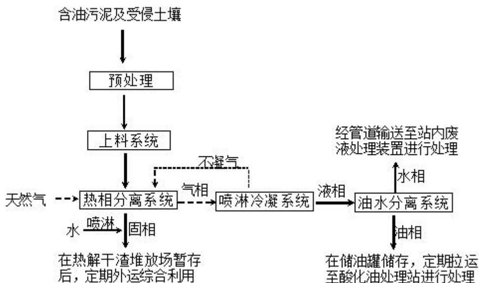
图 3.1-14 含油污泥处理工艺流程
