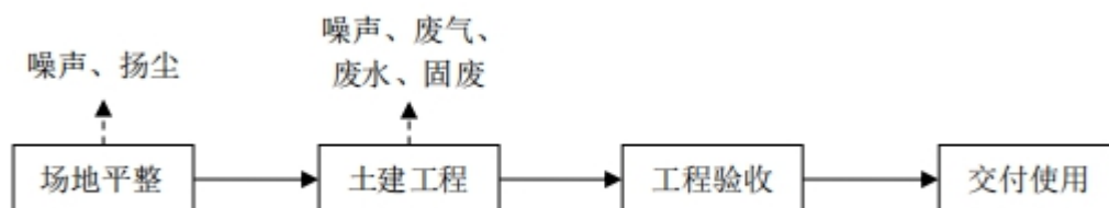
图 3.2-1 施工期工艺流程及产污环节图
