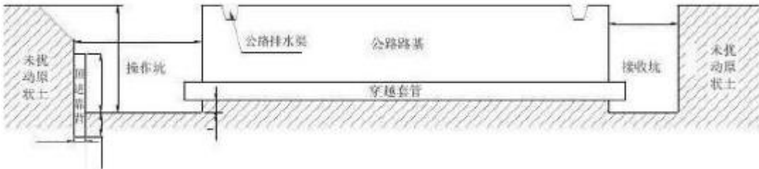
图 3.3-3 穿越农田段管道施工方式断面示意图
