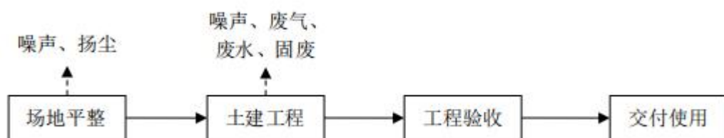
图 3.2-1 施工期工艺流程及产污环节图
