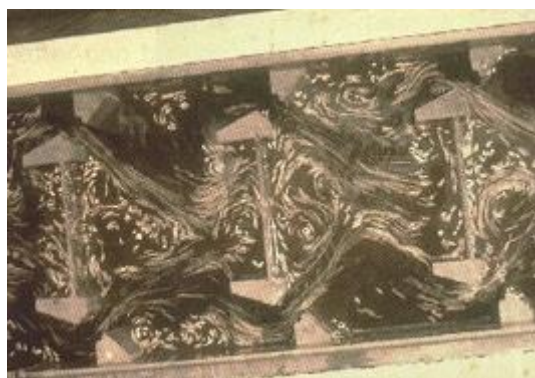
图 7.7.2-4 Dordogne 的 Bergerac 坝双侧竖缝式鱼道的水力模型
