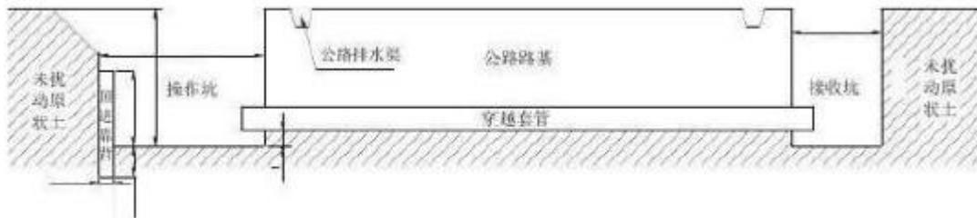
图 3.4-4 穿越道路施工作业示意图
