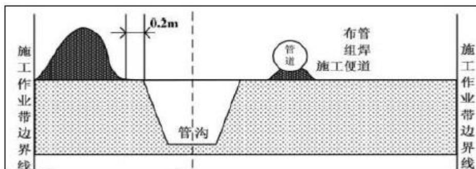
图 3.4-2 一般地段管道施工方式断面示意图
