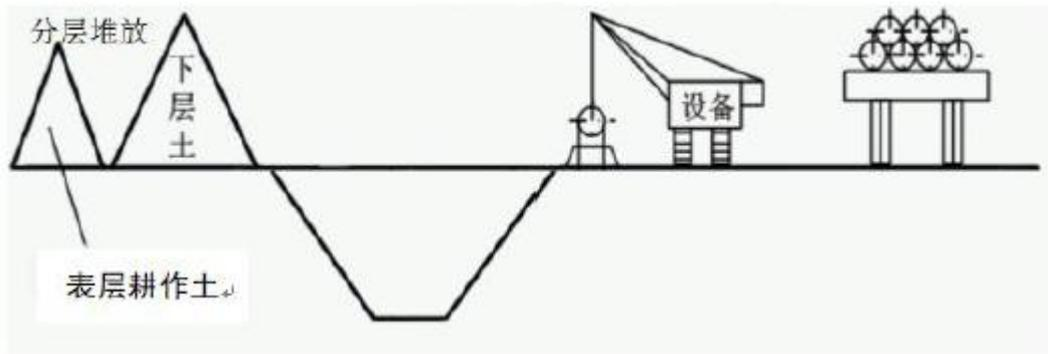
图 3.4-3 穿越农田段管道施工方式断面示意图
