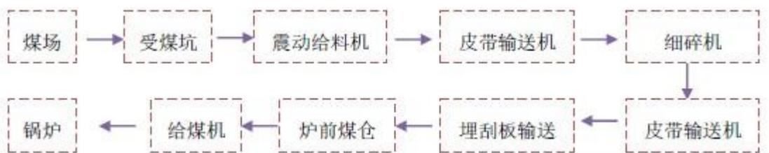
图 3-5 输煤系统工艺流程图
