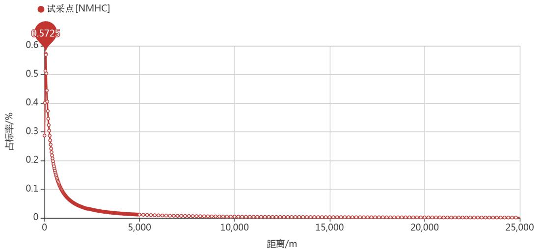
**图 2.4-2 面源最大 P<sub>max</sub> 和 D<sub>10%</sub>预测结果图**
