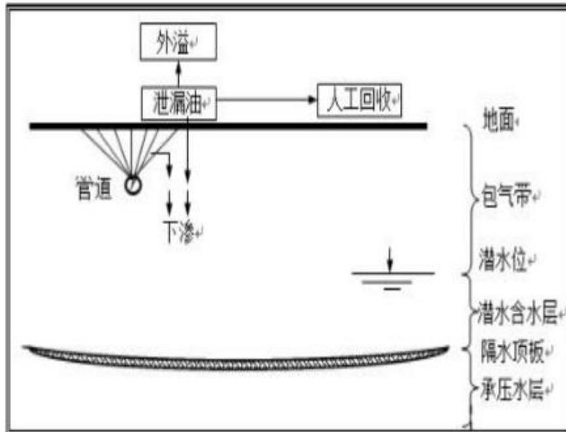
图5.8-1 管道溢油污染过程示意图
