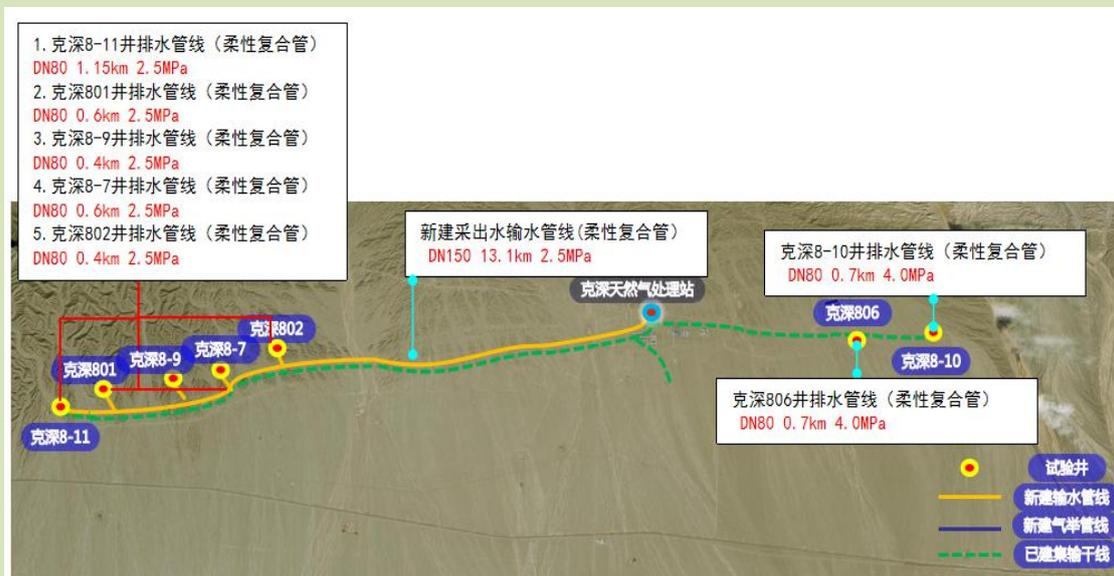
图 3.2-1 排水井场布设及管网走向图
