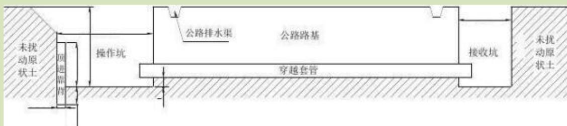
图 3.3-3 穿越道路施工作业示意图
