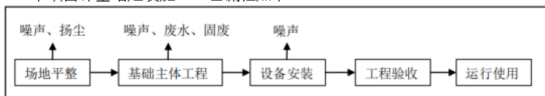
图 2.8-4 站场建设施工工艺流程图
