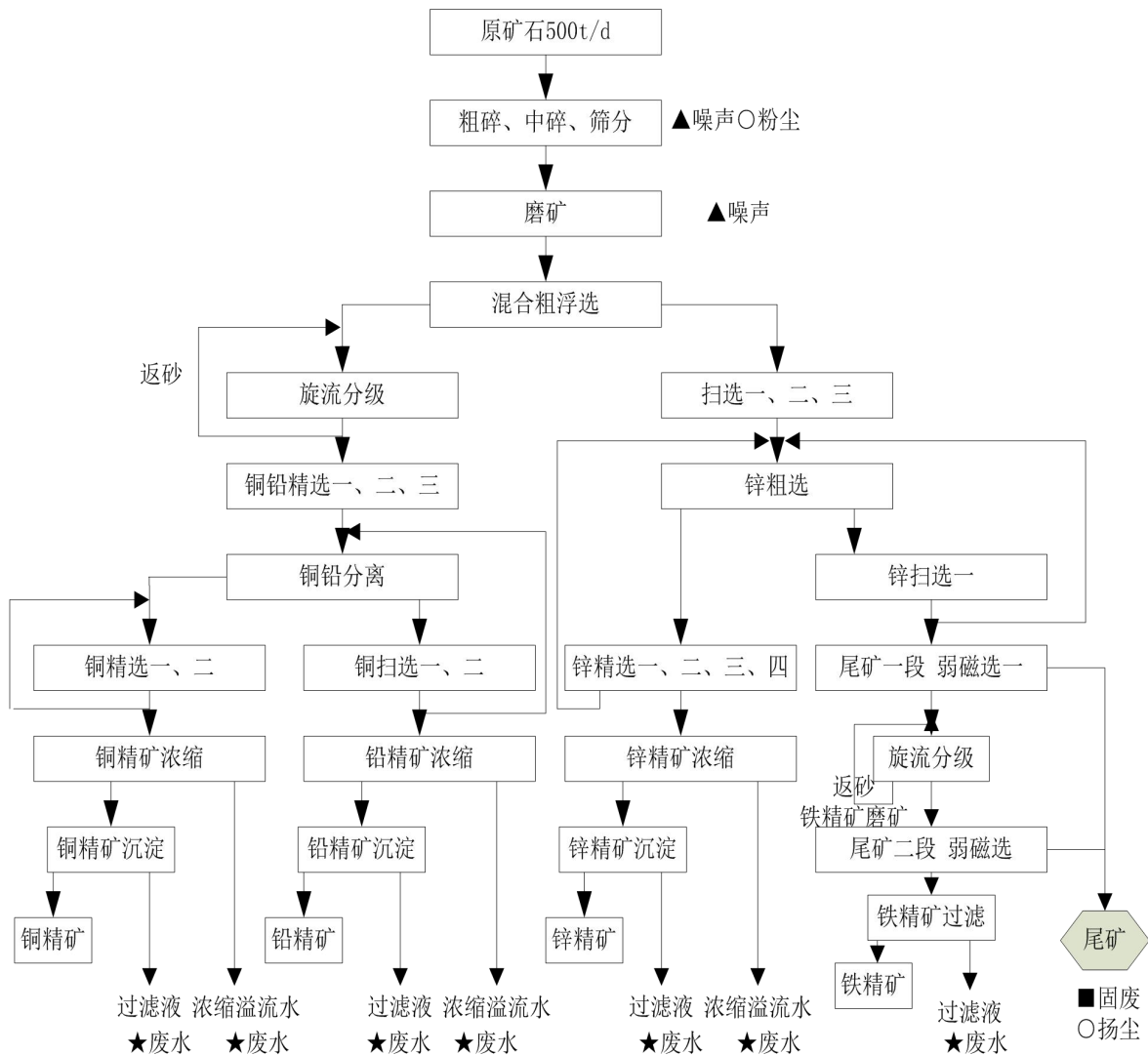
图 3.2-1 现有工程选矿工艺流程及产污环节图
