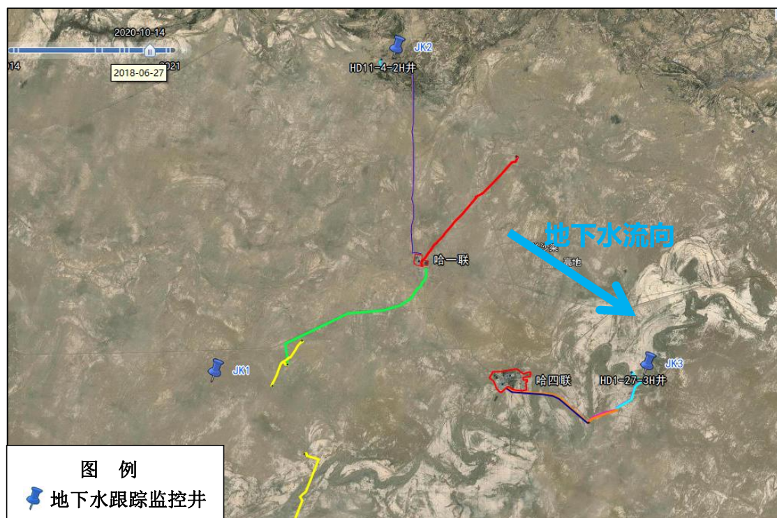
图 5.4-8 地下水监控布点图
