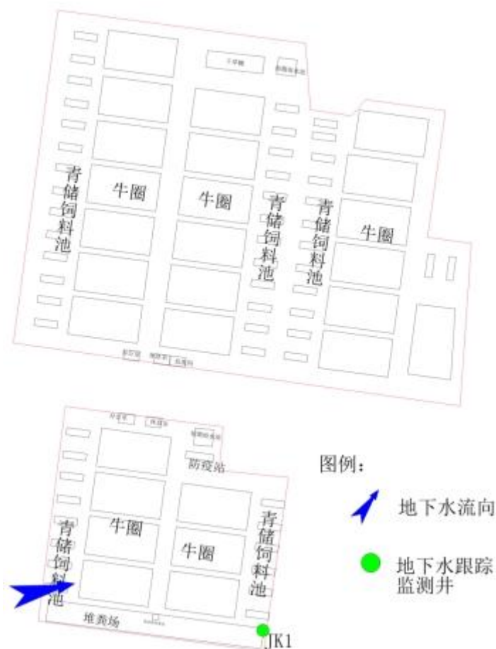
图 5.2.3-13 地下水监控布点图
