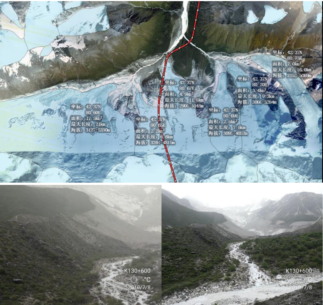
图 5.2-2 什波雷克达坂北坡冰川群分布现状及几何参数及隧道进口冰川河谷沟口
