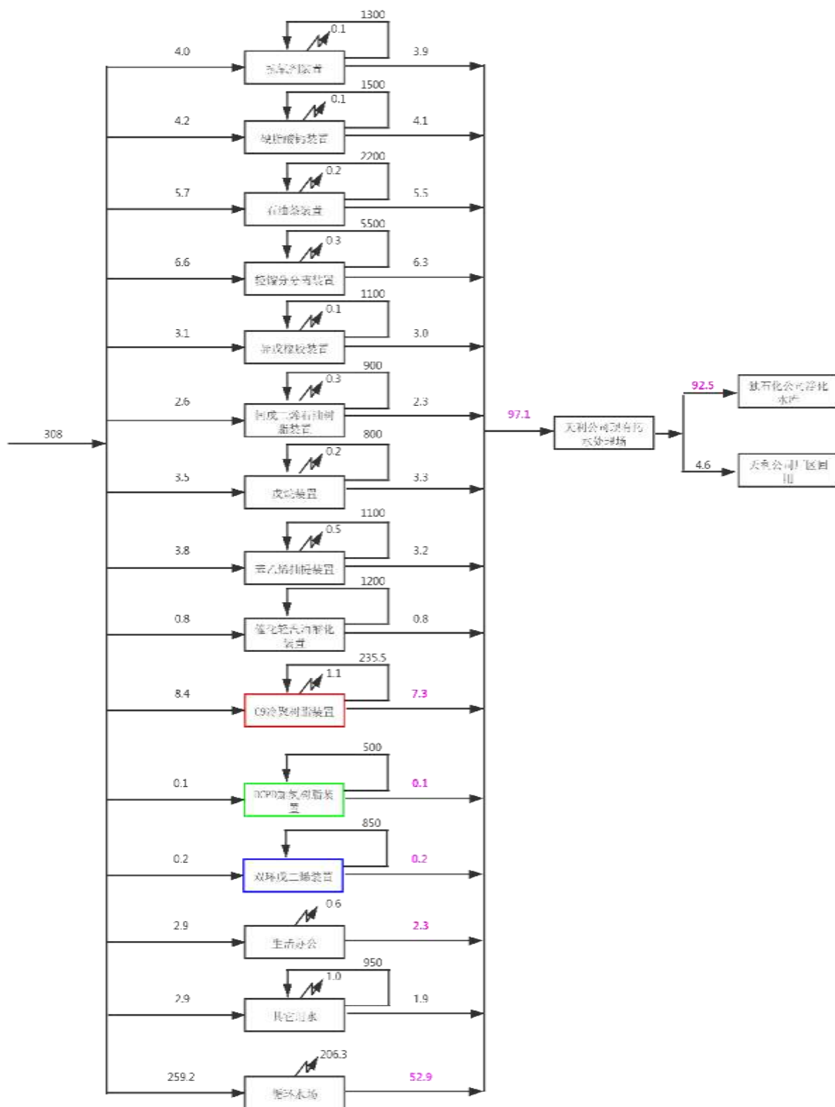
图 3-6-2 在建工程、拟建工程及同步工程实施后天利全厂水平衡图
