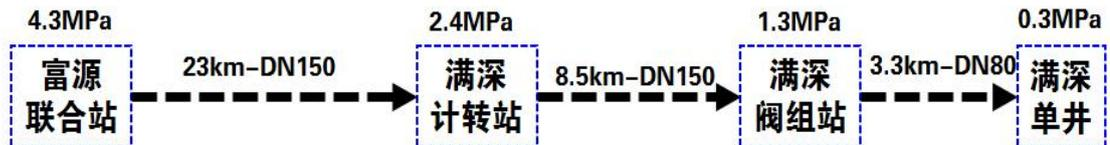
图 3.2-17 各节点压力框图
