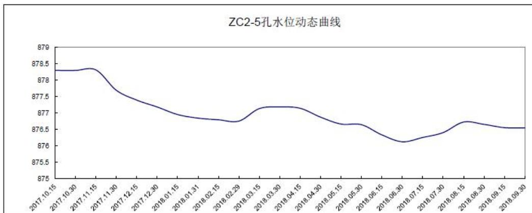
图 5.4-4 区内典型水文地质钻孔地下水动态曲线图（ZC2-5）
