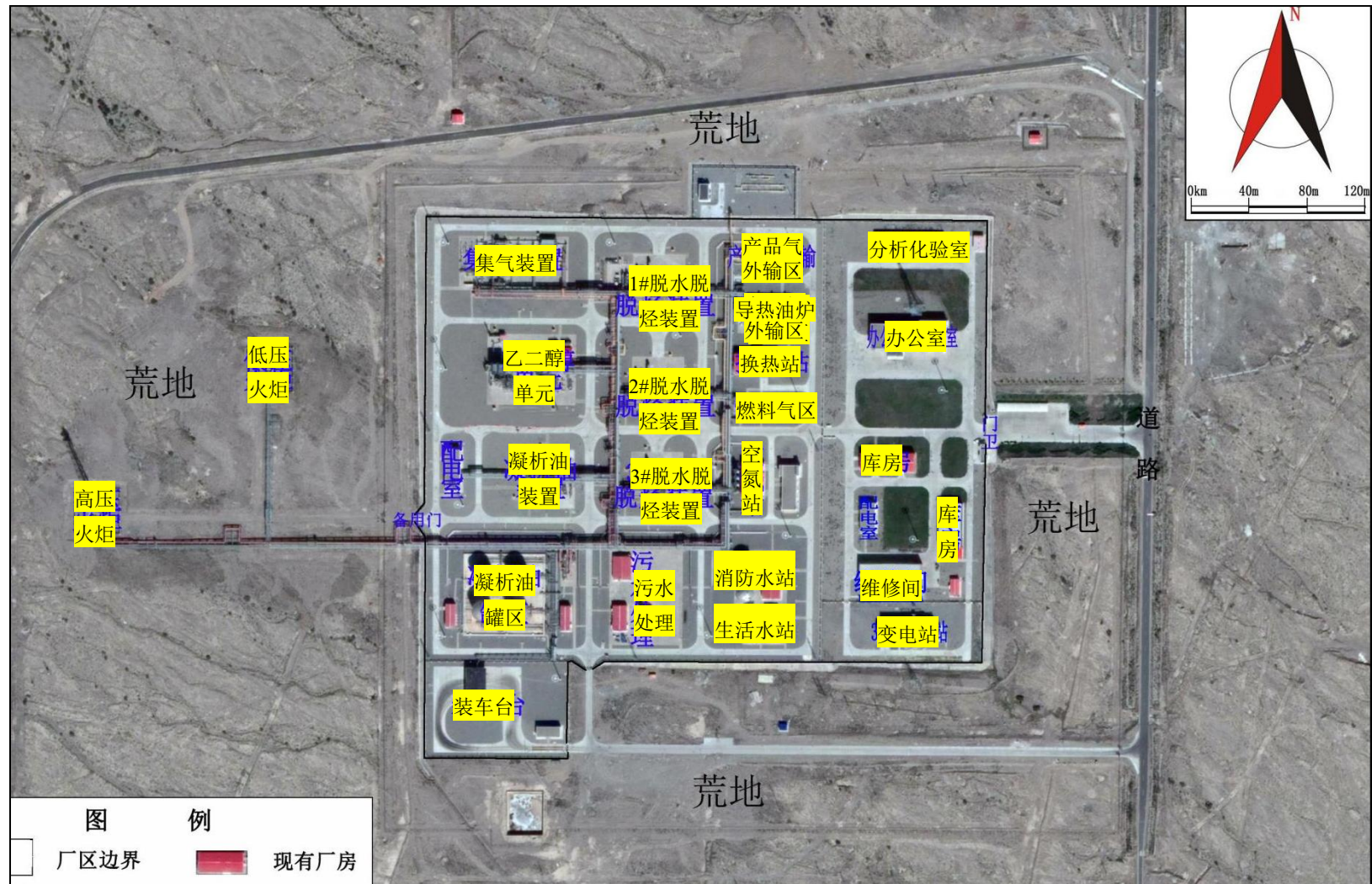
图 3.2-2 大北天然气处理厂平面布置示意图
