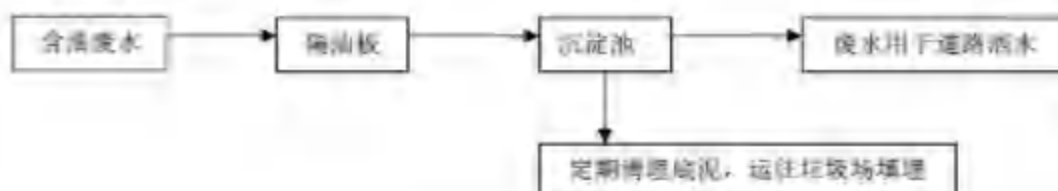
图6.3-1 含油废水处理工艺流程
