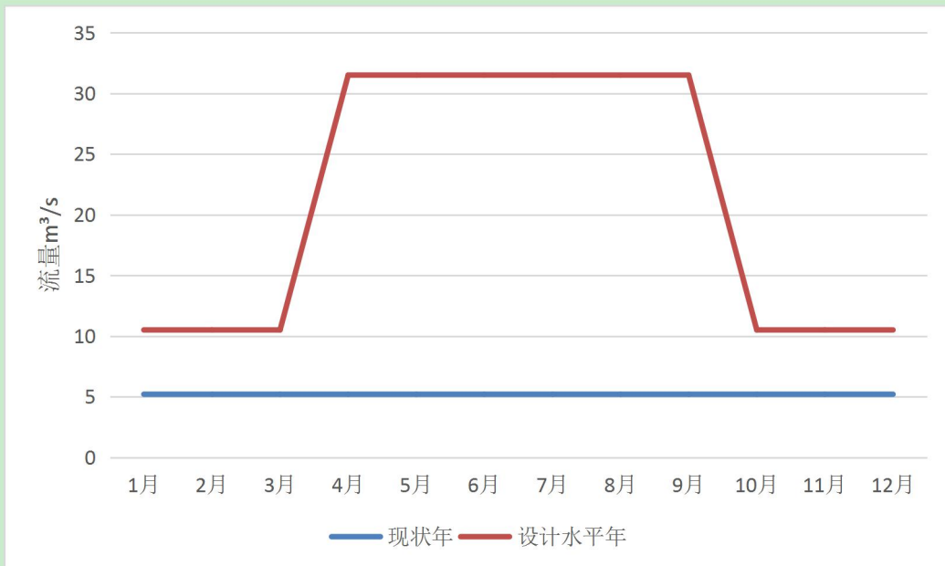
图 6.1-1 察汗乌苏生态电站厂房尾水断面流量变化对比图
