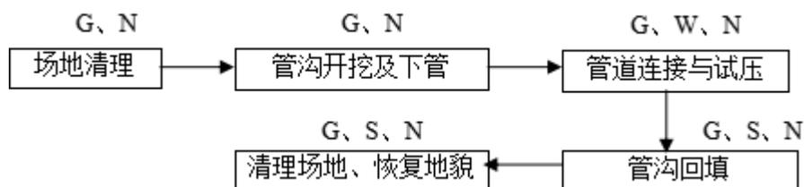
图 3.4-4 油气集输工程工艺流程及排污节点图
