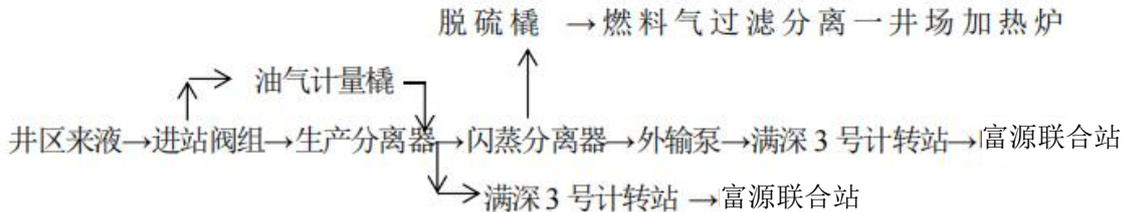
图 3.3-2 富源联合站工艺流程图
