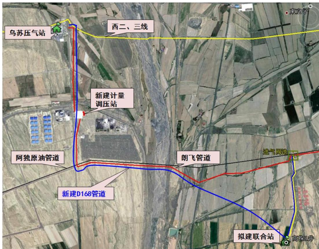
图 3.4-4 天然气外输管线铺设示意图
