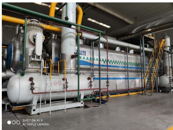
热解油气冷凝回收装置
