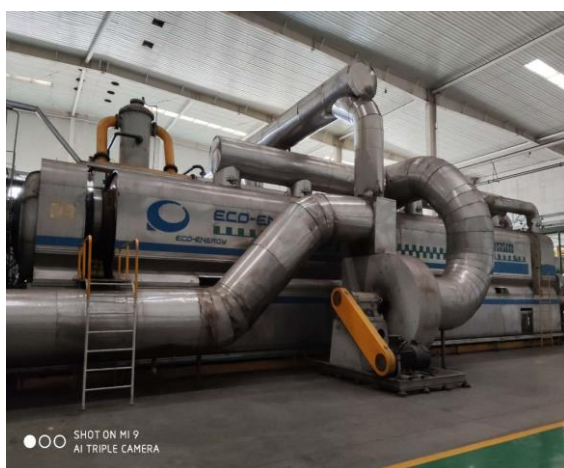
设备主体——热解炉
