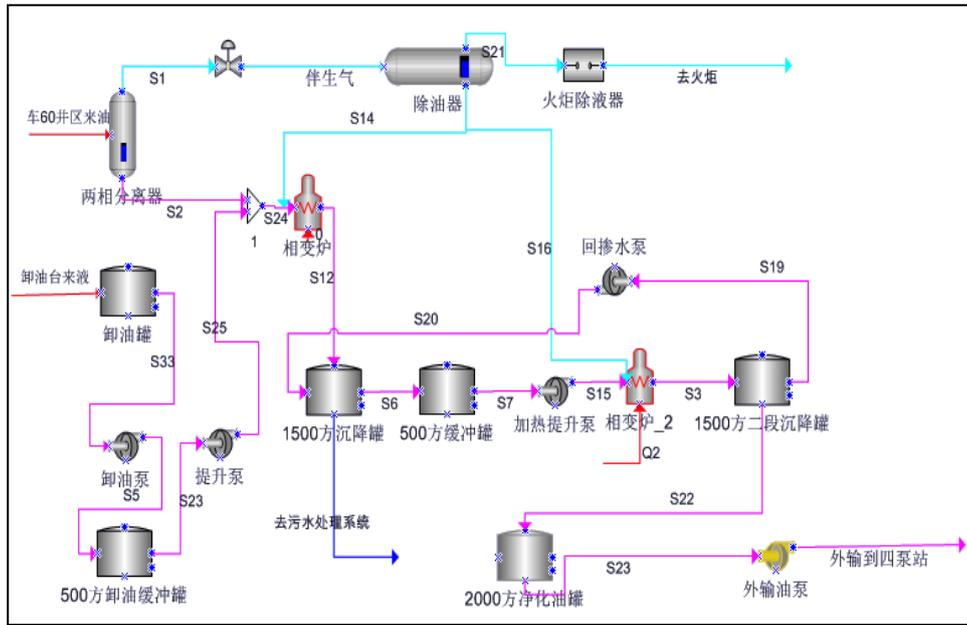
图 8.7-2 车 89 集中处理站原油处理工艺流程图
