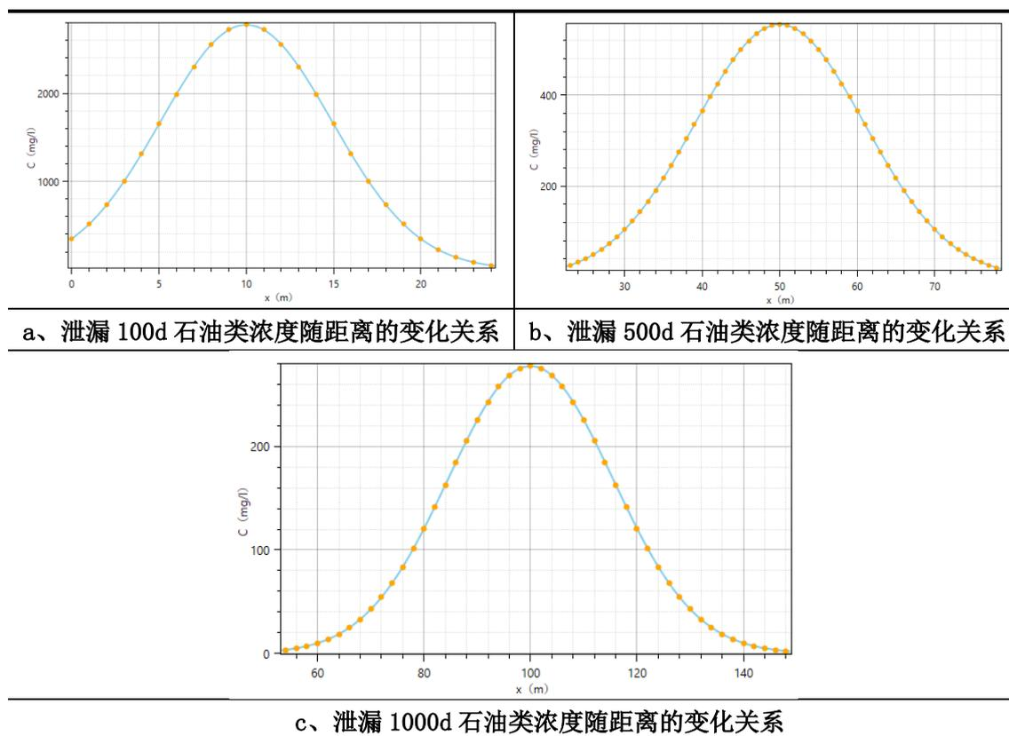
图 6.2-1 单井拉油罐发生泄漏时石油类浓度随距离的变化关系
