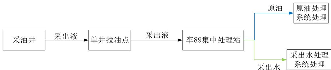
图 4.2-1 本工程采出液运输流程
