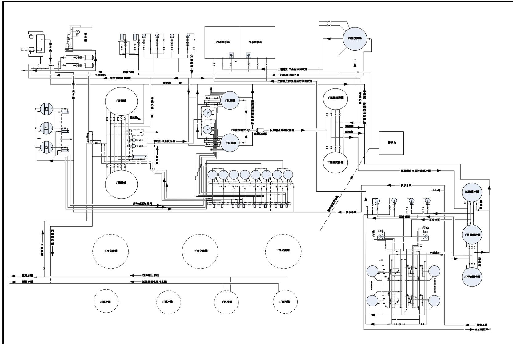
图 8.7-3 车 89 集中处理站采出水处理工艺流程图
