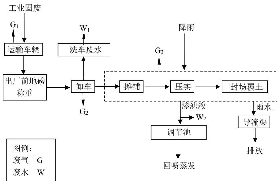
图 2.2-1 填埋工艺排污节点图
