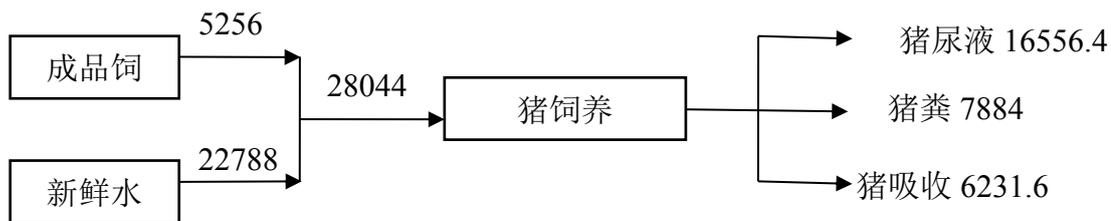
图 3.1-3 物料平衡示意图 单位：t/a
