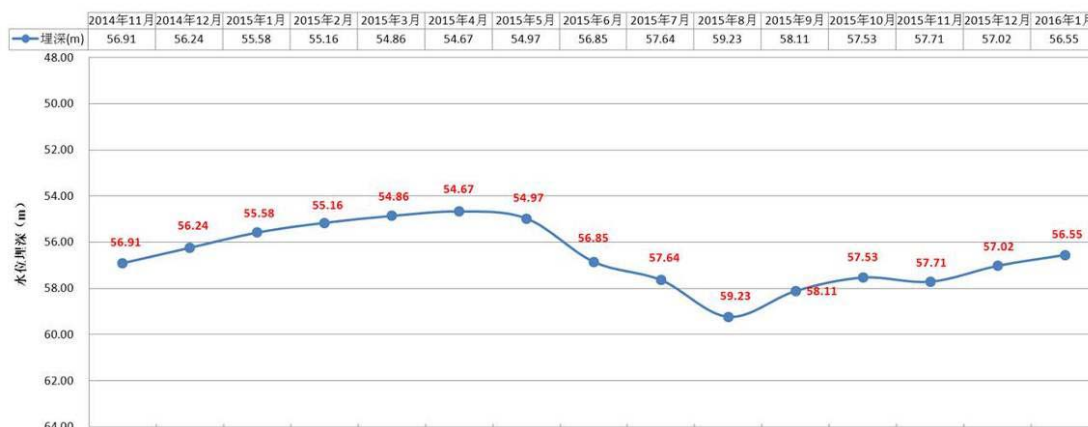
图 5.3-4 CJB004 地下水位埋深动态曲线图
