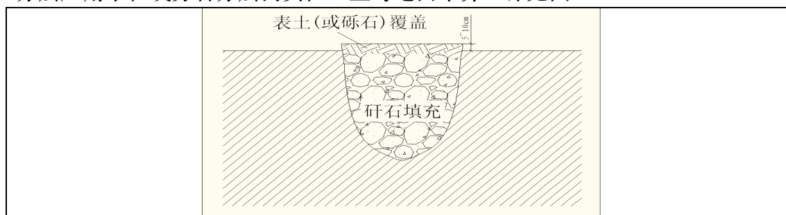
图 8.6-2 裂缝回填区复垦典型断面图
