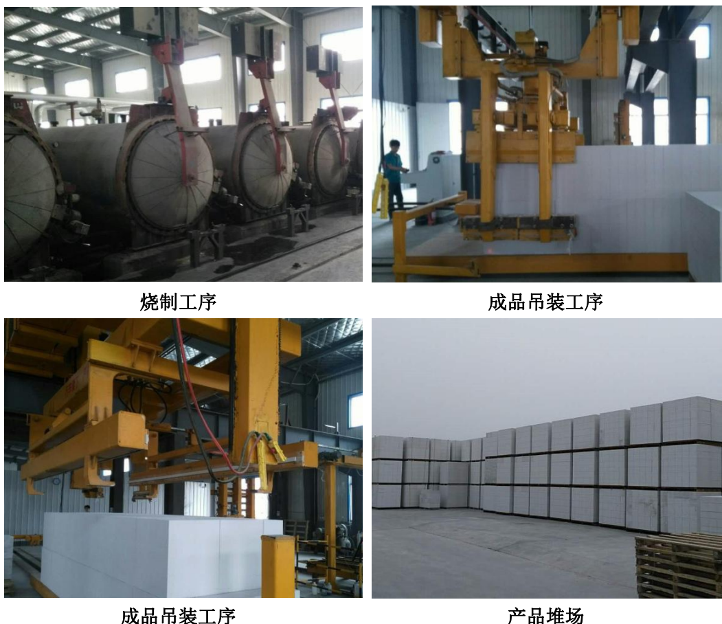
图 3.3-3 青岛市捷能新型材料有限公司年产 30 万 \text{m}^3 砂加气混凝土砌块项目生产运行照片
