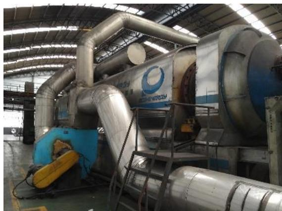
设备主体——裂解炉
