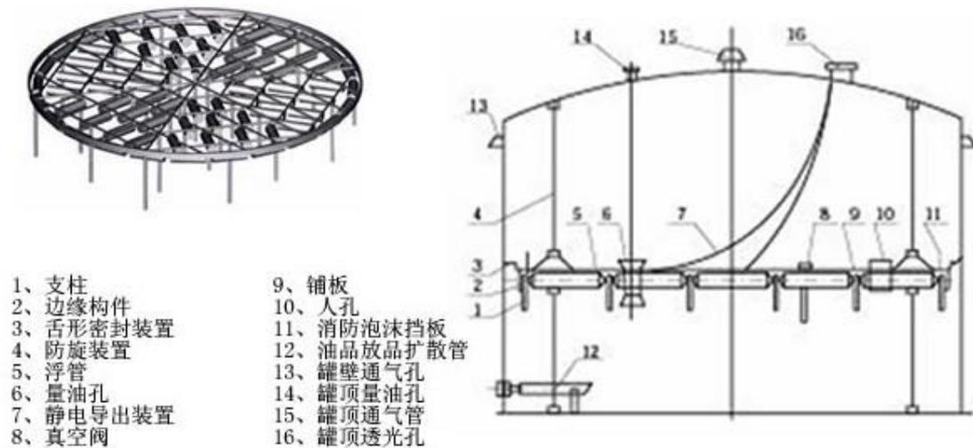
图 6.2-2 典型内浮顶储罐结构示意图
