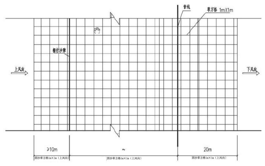
图 6.2-4 移动沙丘固沙平面示意图
