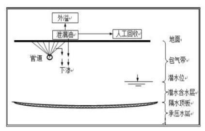
图 5.6-1 溢油污染过程示意图
