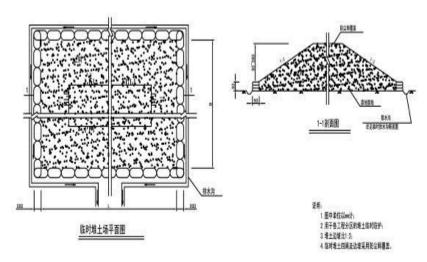
图 6.2-2 临时堆土场防护工程平面布置图
