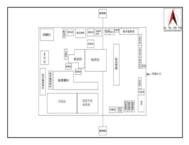
图 3.2-2 井场平面布局示意图
