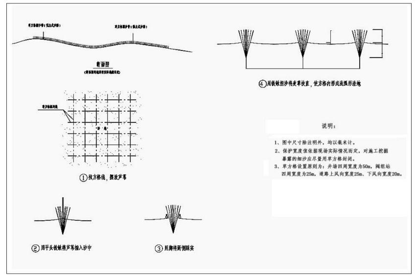
图 6.2-3 固沙草方格设置通用图
