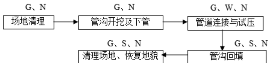
图 3.4-8 油气集输工程工艺流程及排污节点图
