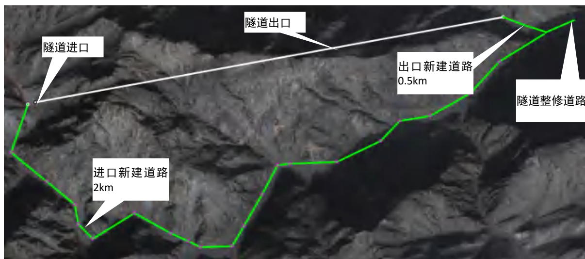
图 4.1-3 隧道新建施工便道示意图
