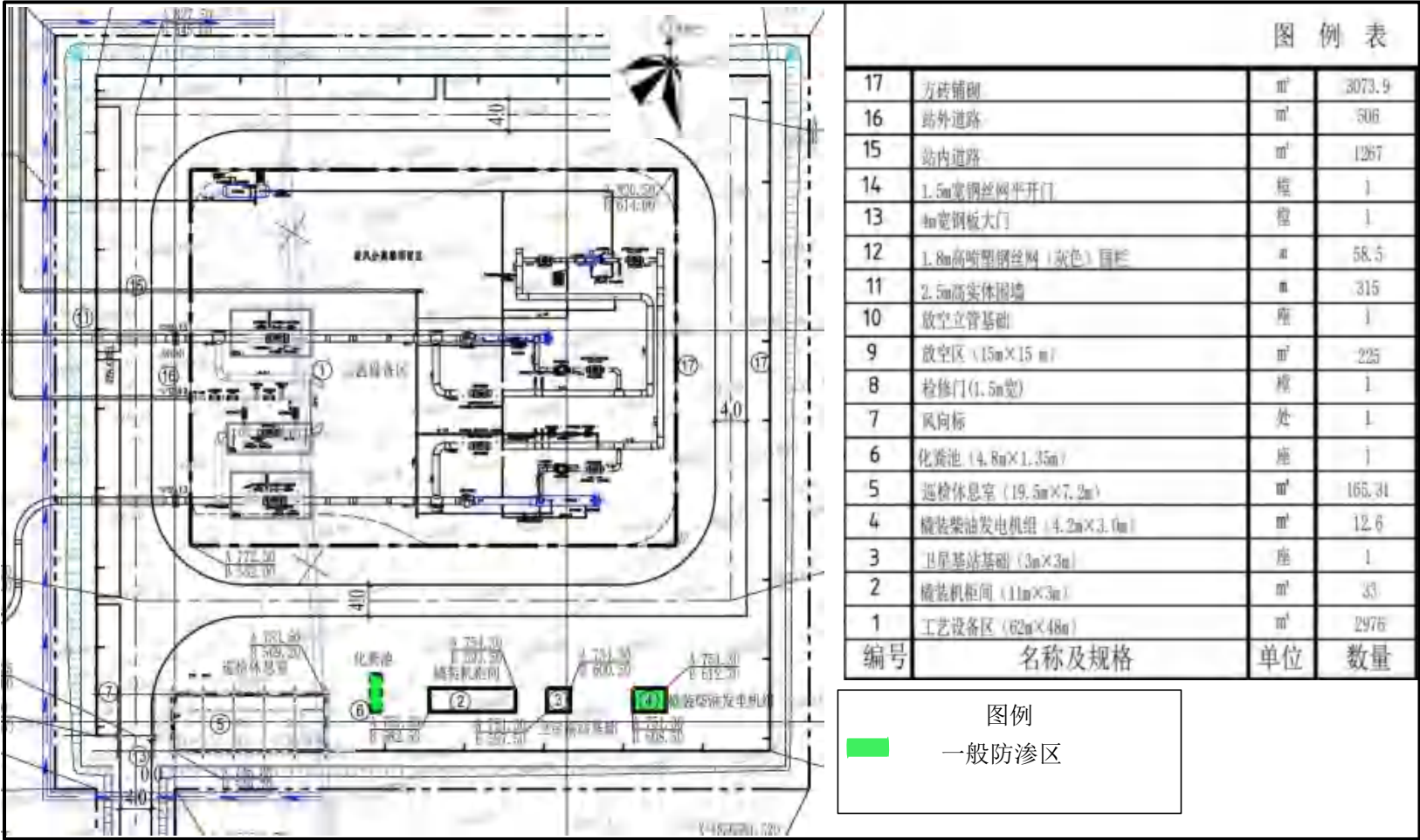
图8.3-2木垒清管站污染防渗分区示意图
