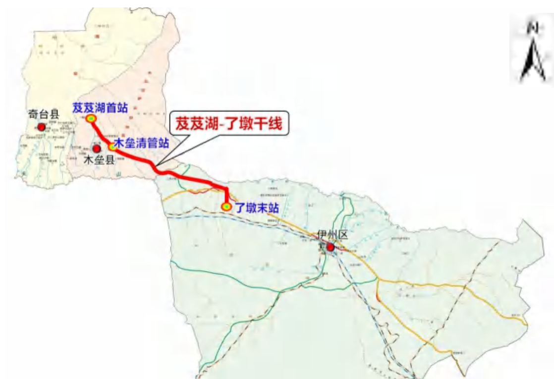
图 3.4-1 管道工程线路总体走向图
