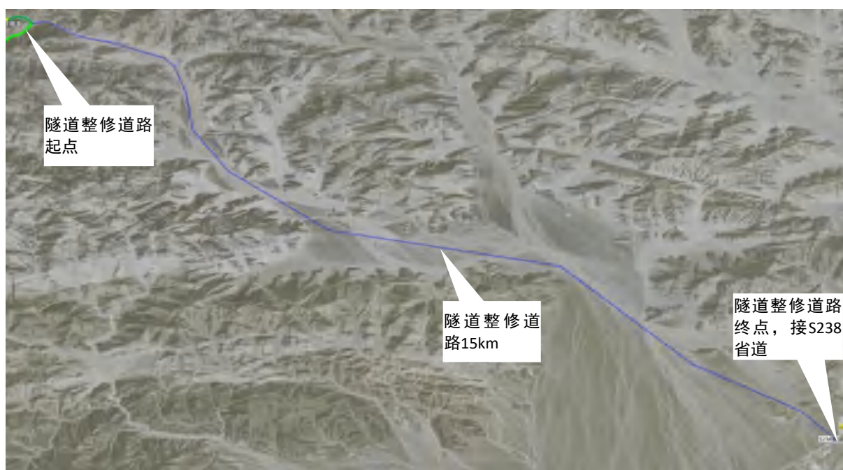
图 4.1-4 隧道整修施工便道示意图
