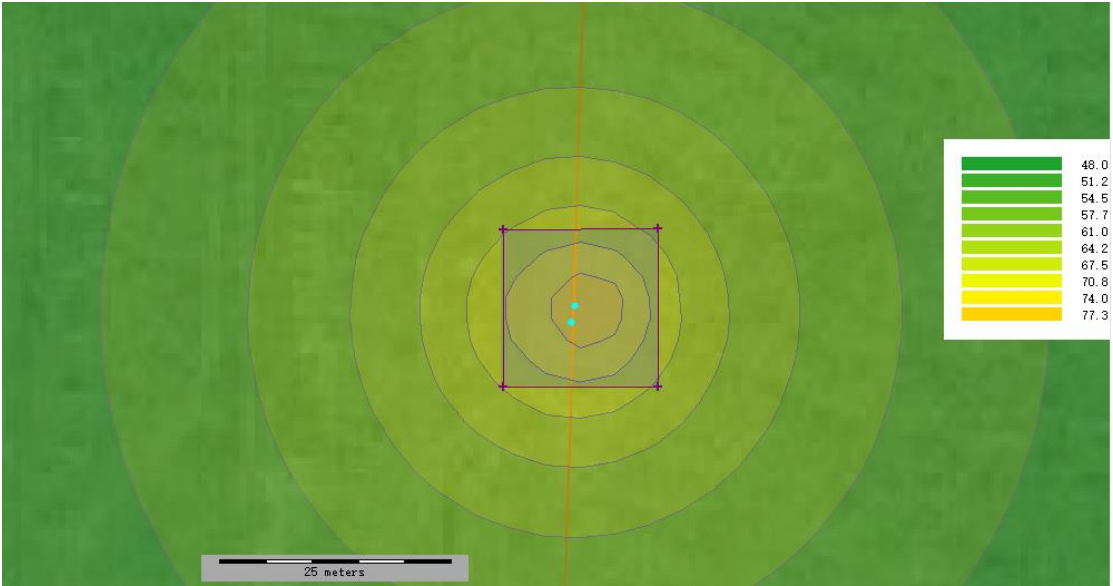
图 6-18 开挖施工场界噪声预测等声级线图
